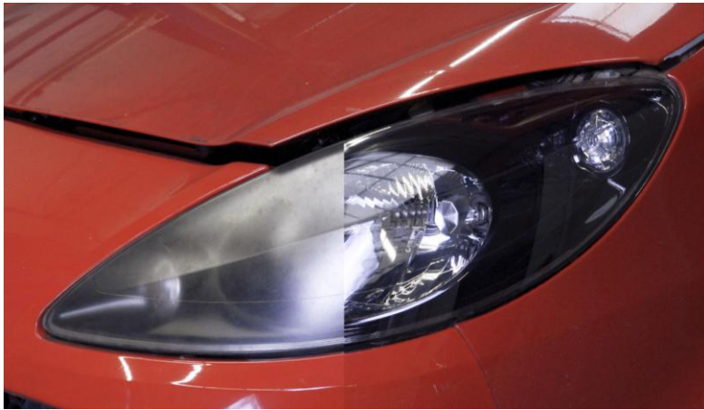
Rénovation à la vapeur
