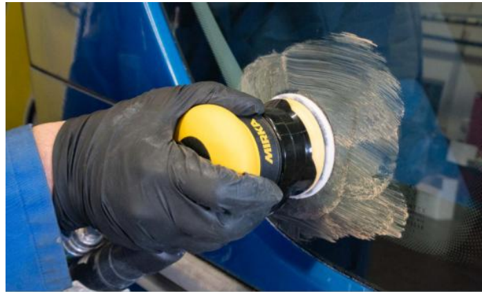
Réparation d'un vitrage rayé
